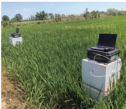
结合客户的土壤通量箱，测量武汉市汉南区水稻田甲烷排放通量
